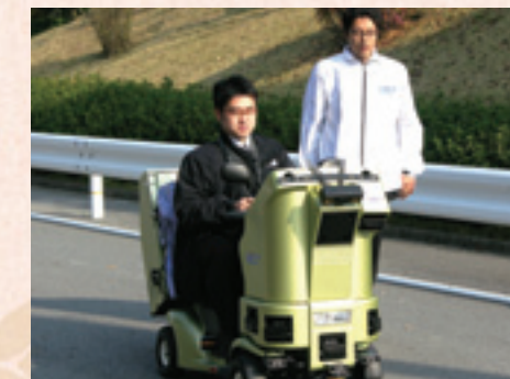
情報通信研究機構 (NICT) 知識創成コミュニケーション研究センター ユーザ搭乗型移動端末「ICW」
